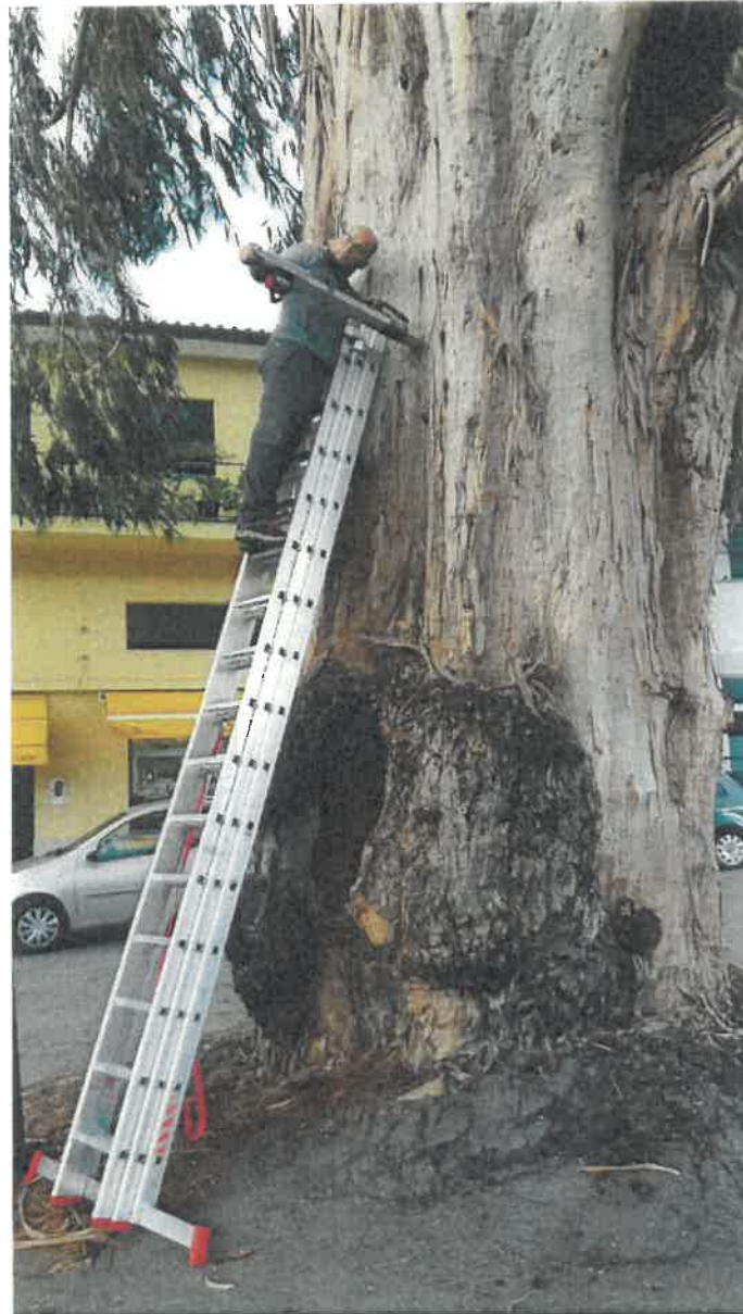
Figura 13 - Leitura efetuada à árvore com Resistógrafo
